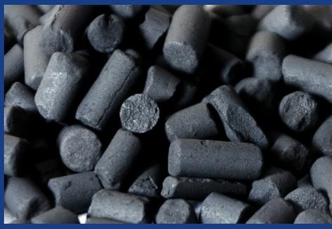
Aktivkohle (BAC) bindet organische Verbindungen an sich. Dadurch ist es möglich, z.B. Gerüche oder Gase aus der Luft zu „filtern“. Genauso lassen sich natürlich auch schädliche Stoffe aus Flüssigkeiten binden.
